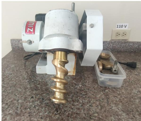
Extrusor utilizado para la elaboración del bocadito paletizado
