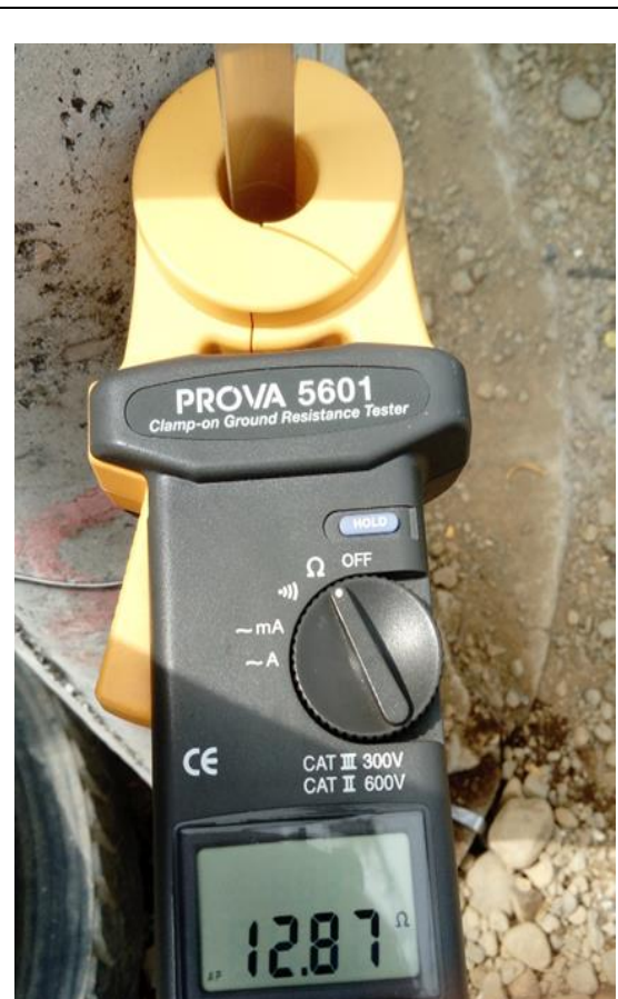
Imagen 13. Sistema de puesta a tierra en acero inoxidable en La Ventura en la ciudad de Babahoyo
