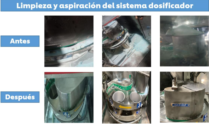
Figura 2.13 Antes y después de expandir la caja de carga en el sistema dosificador
