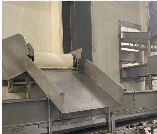
**Figura 2.43 Estructura de traspaso de producto [Fuente: Fabricación propia]**
