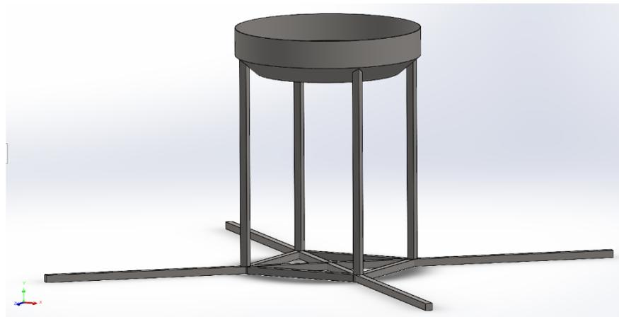
**Figura 2.19 Ensamble de soporte para tolva**
