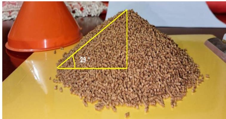
**Figura 2.7 Obtención de ángulo de talud natural del alimento Nicovita 2.0**
