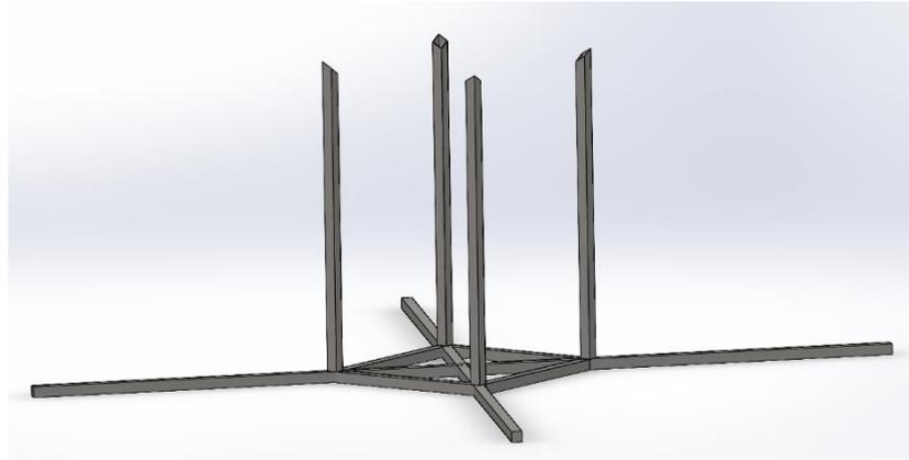
**Figura 2.18 Arreglo de perfiles de acero 304 (40x40xe2mm)**
