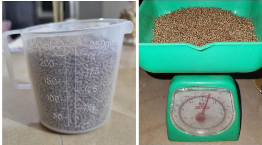
**Figura 2.16 Experimento para calcular la densidad del balanceado. Volumen (izquierda) y masa (derecha)**
