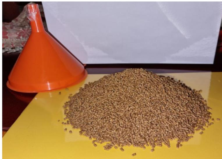
**Figura 2.6 Formación de pendiente de material pelletizado 'Nicovita 2.0'**
