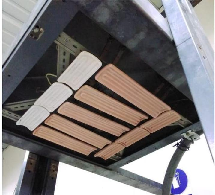
**Figura 2.7: sistema de calentamiento.** [Fuente: Elaboración propia]
