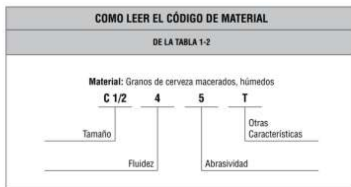
Figura 2.11 Nomenclatura del material. [Martin Sprocket & Gear, Inc., 2022]
