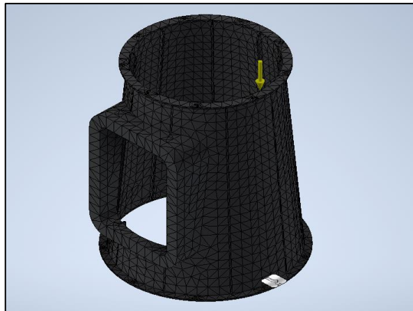
Figura 2.10 Mallado de estructura principal, definidas los apoyos fijos, la fuerza gravitatoria y las cargas aplicadas.
