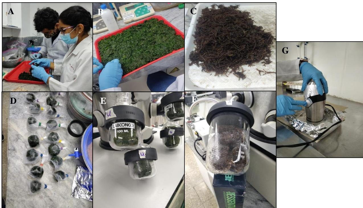
Nota. A) Limpieza manual de muestra de *Ulva* sp.; B) Muestra limpia de *Ulva* sp.; C) Muestra limpia de *Acanthophora spicifera*; D) Muestra de *Ulva* sp. acondicionada para el liofilizador; E) Muestra de *Ulva* sp. dentro del liofilizador; F) Muestra de *Acanthophora spicifera* dentro del liofilizador. G) Trituración de *Acanthophora spicifera*.
