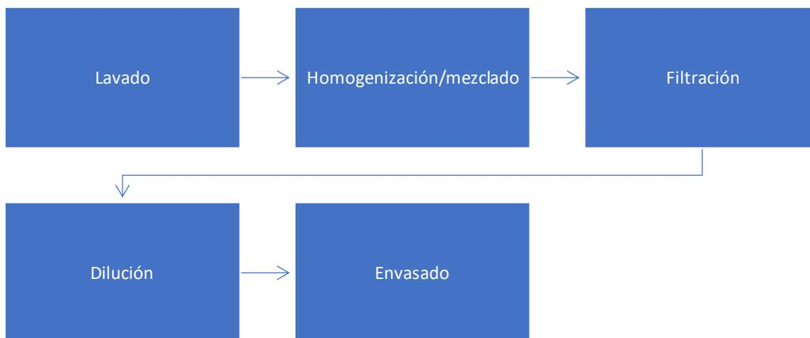
Se recolectó información de los equipos requeridos para la tecnología de la planta como lo son las dimensiones, material, capacidad, voltaje, potencia y costo estimado. Además, se analizó la cantidad de equipos, consumo energético, consumo y costo estimado de reactivos y materia prima y se utilizó los resultados de la cuantificación realizada en el laboratorio. Toda esta información es usada para la proyección de rentabilidad de la planta propuesta.
