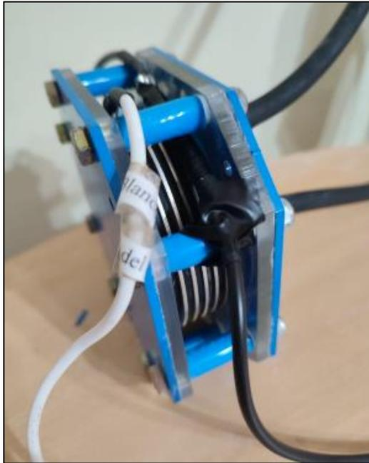
**Figura 3.4. Integración del módulo sensor de temperatura.**
