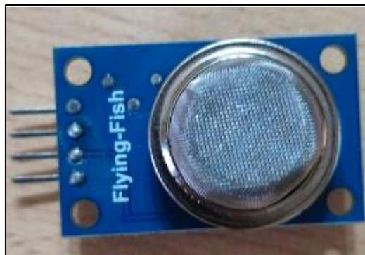
Figura 2.3. Módulo sensor de gas Hidrógeno MQ-8
