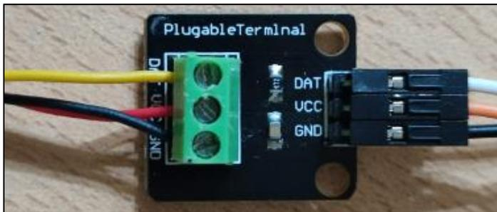
**Figura 2.5. Sensor de Temperatura DS18B20**
