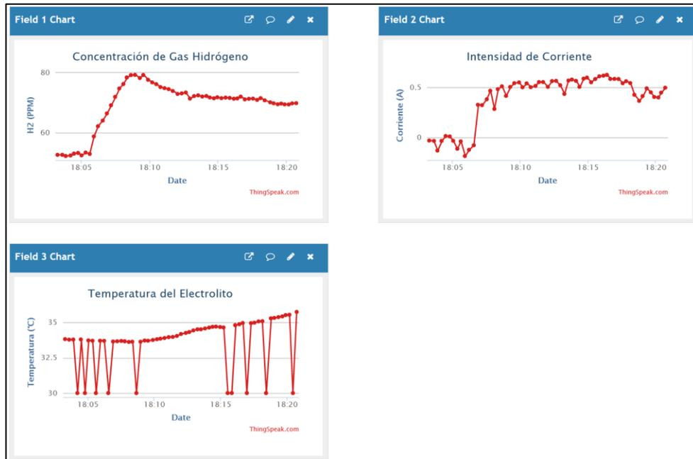
**Figura 3.7. Plataforma ThingSpeak recibiendo datos del módulo ESP32.**
