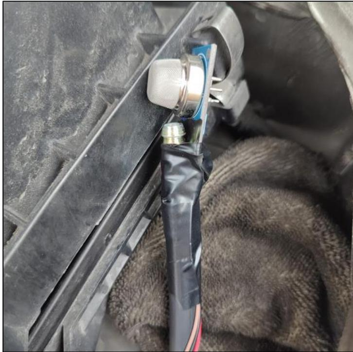
**Figura 3.5. Integración del módulo de detección de Hidrógeno.**
