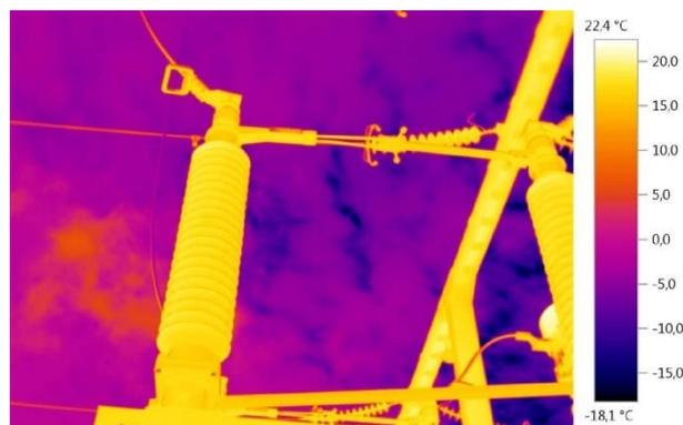
**Ilustración 2: Termografía realizada en conexiones de alta tensión (Testo, s.f.).**
