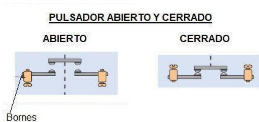
Figura 5 Funcionamiento de una botonera tipo pulsante
