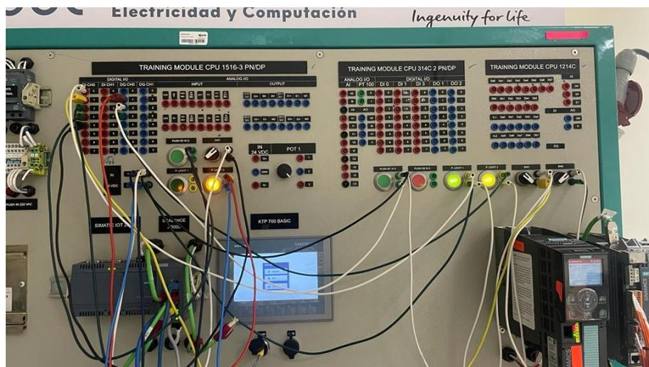
Ilustración 7 Interconexión de las diferentes entradas digitales al S7-1500
