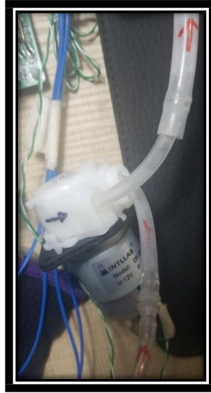
Figura 2.8 Subsistema bomba Peristáltica.
