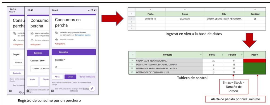
**Figura 2.14 Sistema de control digitalizado [Elaboración propia]**
