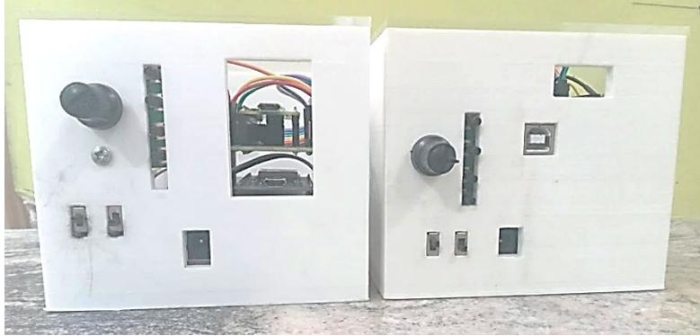
Figura 48. Equipos implementados, ESP32-ARDUINO UNO-TSCLAB vista frontal.
