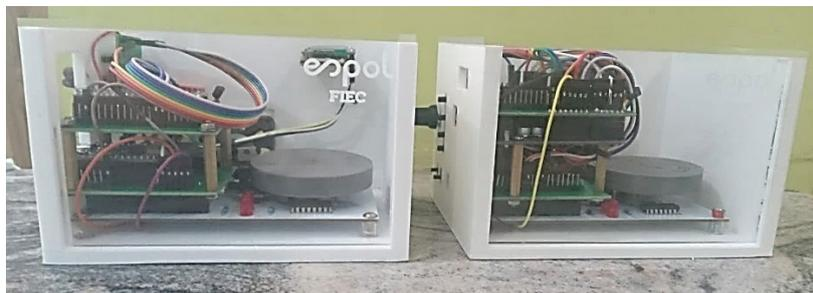
Figura 50. Equipos implementados, ESP32-ARDUINO UNO-TSCLAB vista lateral.
