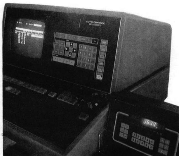
2.- Un sistema de dosificación de ingredientes computarizado, el cual evita los muy frecuentes errores de operación, usuales en otro tipo de plantas y que causan desbalance en las formulaciones.
