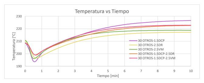
En todos los casos, la plastificación que se produce a partir del minuto 3 ocurre debido a una reacción de funcionalización entre el DCP y la matriz, dando paso al entrecruzamiento de las cadenas poliméricas del PEAD y el material de relleno; este proceso es de carácter exotérmico debido a que existe una formación de radicales que conducen al proceso de polimerización.
