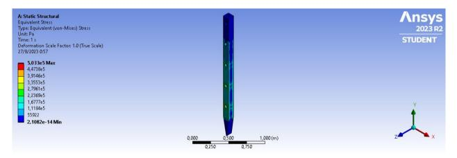
La tensión equivalente muestra un valor máximo 0.05 MPa, el cual se evidencia en los bordes de los agujeros por los cuáles pasaría el alambrado (puntos en donde se ubicaron las
