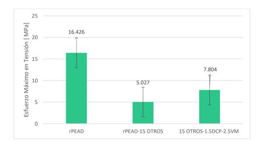
La incorporación de DCP y Vistamax mejoró la compatibilidad de los polímeros, dado que estos se encuentran en la interfase y aumentan la adhesión interfacial del compuesto. Sin embargo, la presencia de poli componentes en el material de relleno aumenta la incompatibilidad
