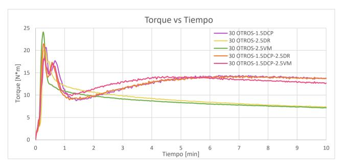
Además, para las mezclas 30Otros-1.5DCP, 30Otros-1.5DCP-2.5DR y 30Otros-1.5DCP-2.5VM, se requiere un menor torque y tiempo para iniciar el mezclado del compuesto, siendo esta última la que requiere un menor torque, es decir, menor resistencia al mezclado, lo cual es una característica importante a considerar para la procesabilidad del material final.
