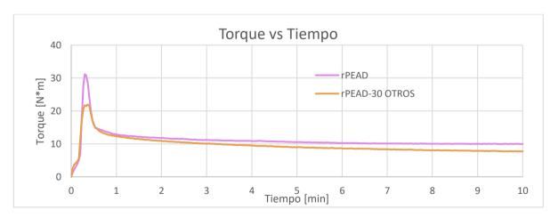
Se observa un incremento del torque en la Figura 3.1 para ambas mezclas alrededor del primer minuto, esto indica que el material se está fundiendo, lo que sugiere un aumento en la resistencia al mezclado. Posteriormente, en ambos casos, se produce una reducción del torque, en donde existe únicamente una etapa de fundición más no de plastificación, lo que conduce a una
