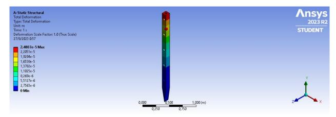
El alargamiento total que sufre la estaca (escala real) denota un valor máximo de 0.0248 milímetros ubicado en la parte superior del elemento, valor que no afecta el funcionamiento de la estaca.
