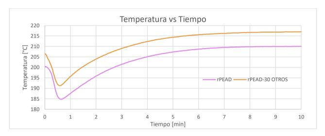
La Figura 3.3 y Figura 3.4 presentan el comportamiento reométrico de las formulaciones que contienen aditivos. En la Figura 3.3, se observa que antes del primer minuto todas las muestras presentan un incremento en el torque ya que, el rPEAD no se ha fundido completamente. Por lo tanto, en la Figura 3.4 se evidencia una disminución en la temperatura de procesamiento, dando paso a un proceso endotérmico en el que se funden los materiales que conforman el compuesto [26].
