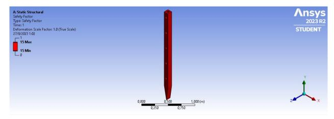
Finalmente, el factor de seguridad fue de 15 para todas las partes de la estaca, por lo que se asume que el material obtenido es completamente óptimo para ser procesado y utilizado como estacas para cercar.
