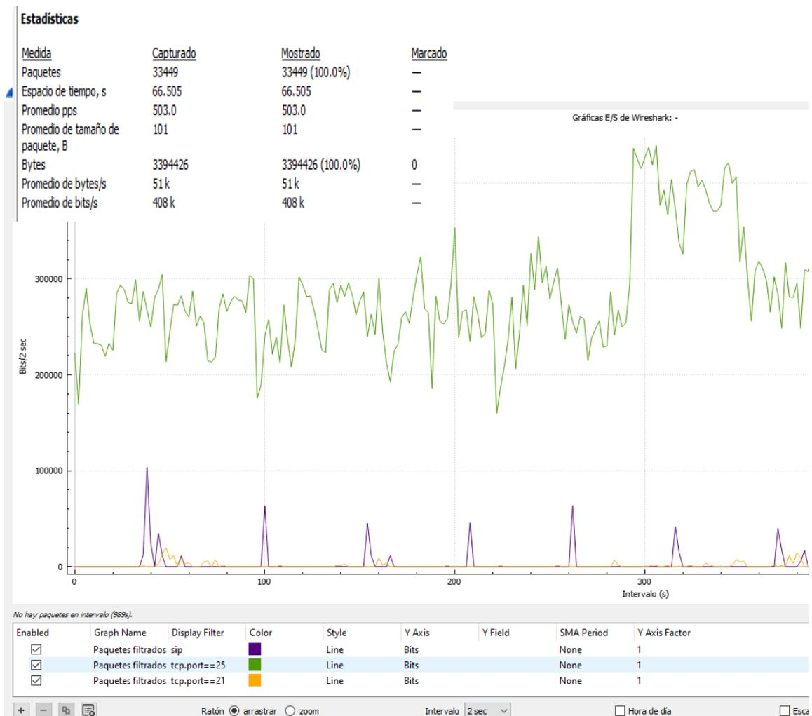
**Fig. 9.** Se visualiza los 3 tipos de tráfico generados a través de la red VoIP con QoS mediante Wireshark y su promedio de bits/s.
