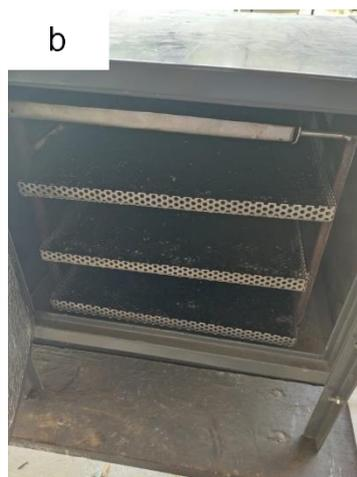
Nota: a) Secado en el secador de bandejas del LOPU; b) Secado en el secador de bandeja de CDTS
