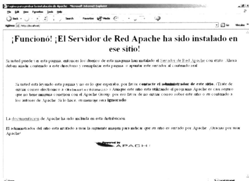
Figura B.10 Prueba de la instalación de Apache
