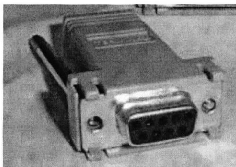
Fig. 5.9 Adaptador RJ-45 o DB-9
