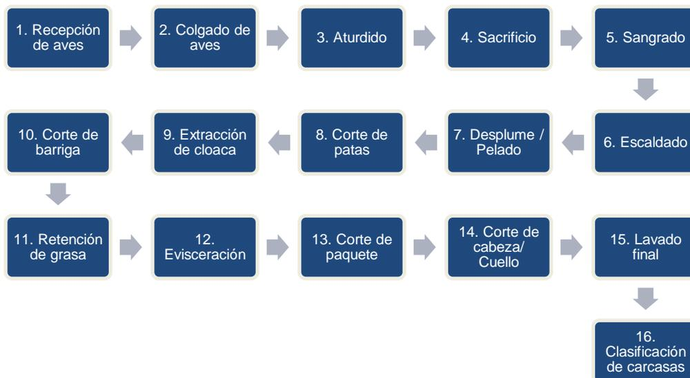
**Figura 1.1 Flujo del proceso de producción de pollo**
