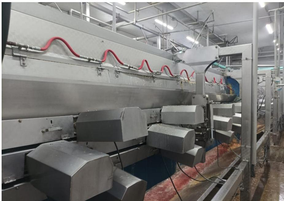
**Figura 2.2 Máquina peladora del área de desplume de la planta**
