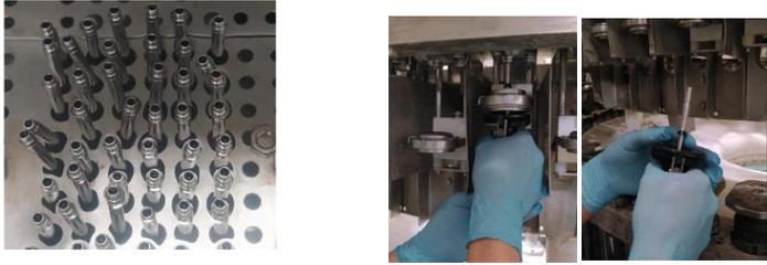
Validación de daño de cada uno de los tubos de venteo y toma de medición en caso se hayan cambiado sin previo aviso y no respetando el estandar de medida.
