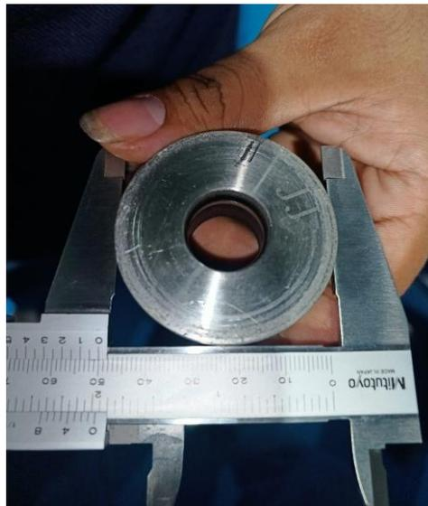
**Figura 2.47 Medición y verificación de sellos de válvula**
