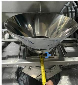
**Antes:** Existía un espacio entre la tolva de descarga y la base de la entrada al sistema de envasado (el espacio era de 1.8 centímetros lo cual permitía la fuga de polvo a toda la cabina del ISHIDA por medio de esta abertura)
