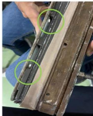
Figura 2.14 Cuerpo de cuchilla con la colocación de pernos prisioneros (después)
