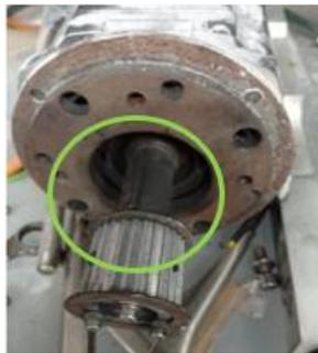
Figura 2.18 Antes de cambio de polea principal de Servo
