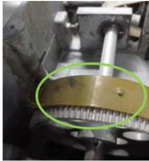
Figura 2.16 Antes del cambio de correa dentada sincrónica.
