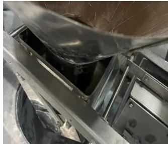
**Después:** Se realizo con el equipo de Mantenimiento una tolva que cuenta con una estructura que acopla totalmente al espacio superior de la tolva de descarga como se muestra en la imagen. Con esta estructura ya no existe fuga de detergente por que elimina el espacio 1.8 centímetros que permitan el paso de detergente.
