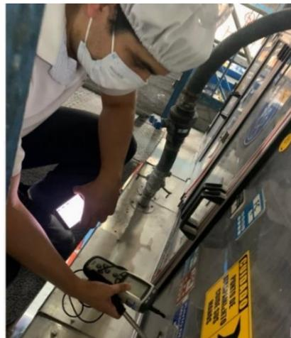
Figura 2.12 Toma de medición de velocidad de aspiración con herramienta anemómetro
