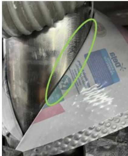
Figura 2.20 Correcto deslizamiento de lámina primaria a través de tubo formador y hombrera.
