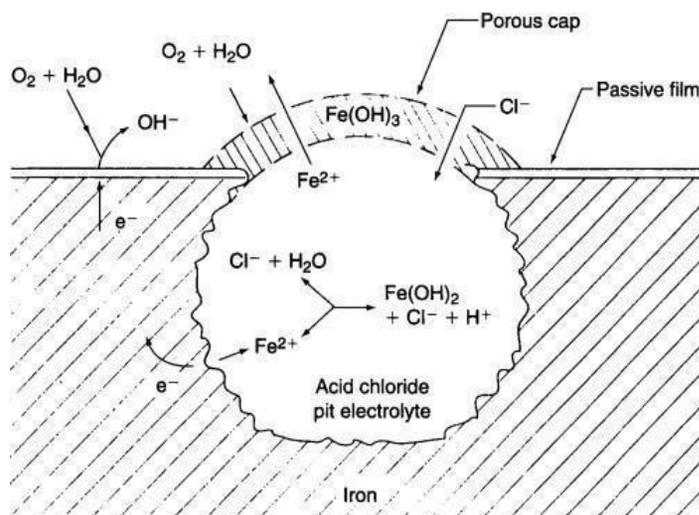
Nota. Corrosión por picaduras en tuberías de metal. Ehrnstén (2020).
