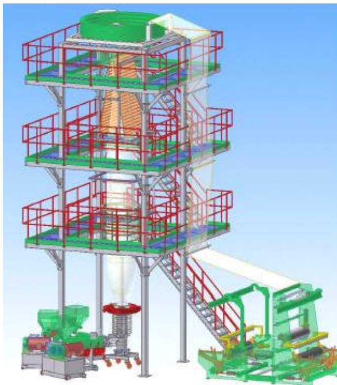
FIGURA 3.13 TORRE DE 3 PISOS PARA COEXTRUSION
