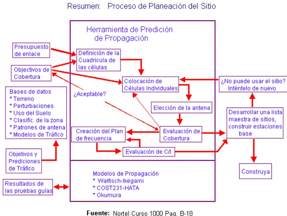
**FIGURA 4.6** Diseño del Sistema y planeación del sitio
