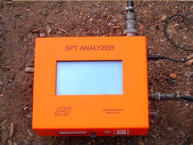
Instrumentos fueron conectados en un Analizador de señales, **SPT Analyzer<sup>TM</sup>** (Pile Dynamics Inc. 2000)
