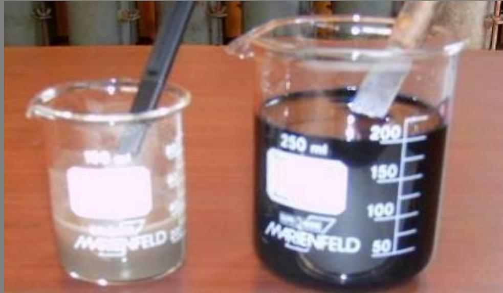
▪ 10.0 gr de suelo secado a horno en 30 ml de agua desionizada.
