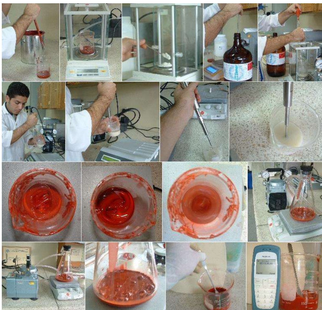
FIGURA 3.23. PROCEDIMIENTO PARA FABRICAR NANOCOMPUESTOS DE RESINAS EPÓXICAS Y NANOARCILLAS.
