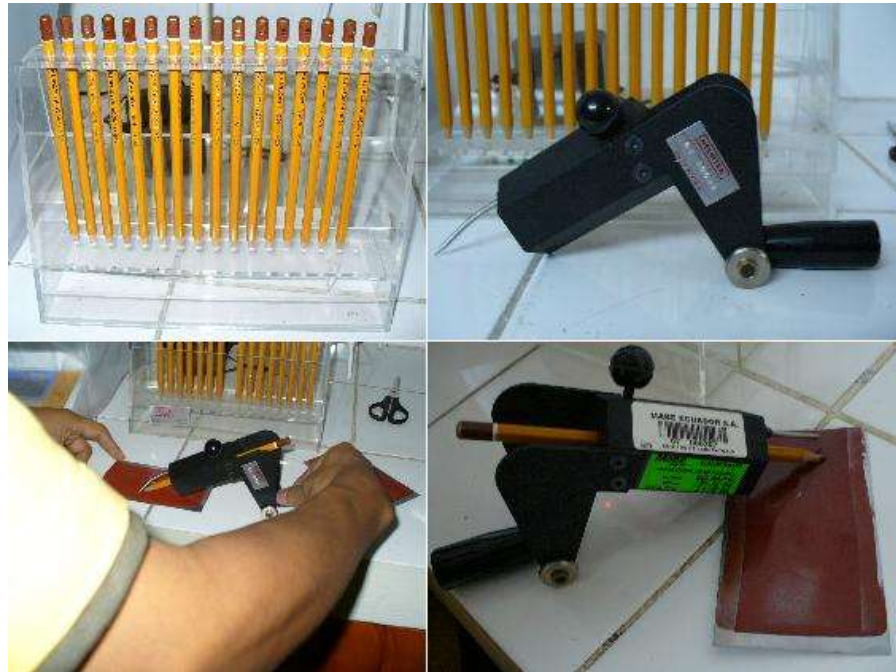
FIGURA 3.25. PRUEBA DE DUREZA AL LÁPIZ INEN 1001.
