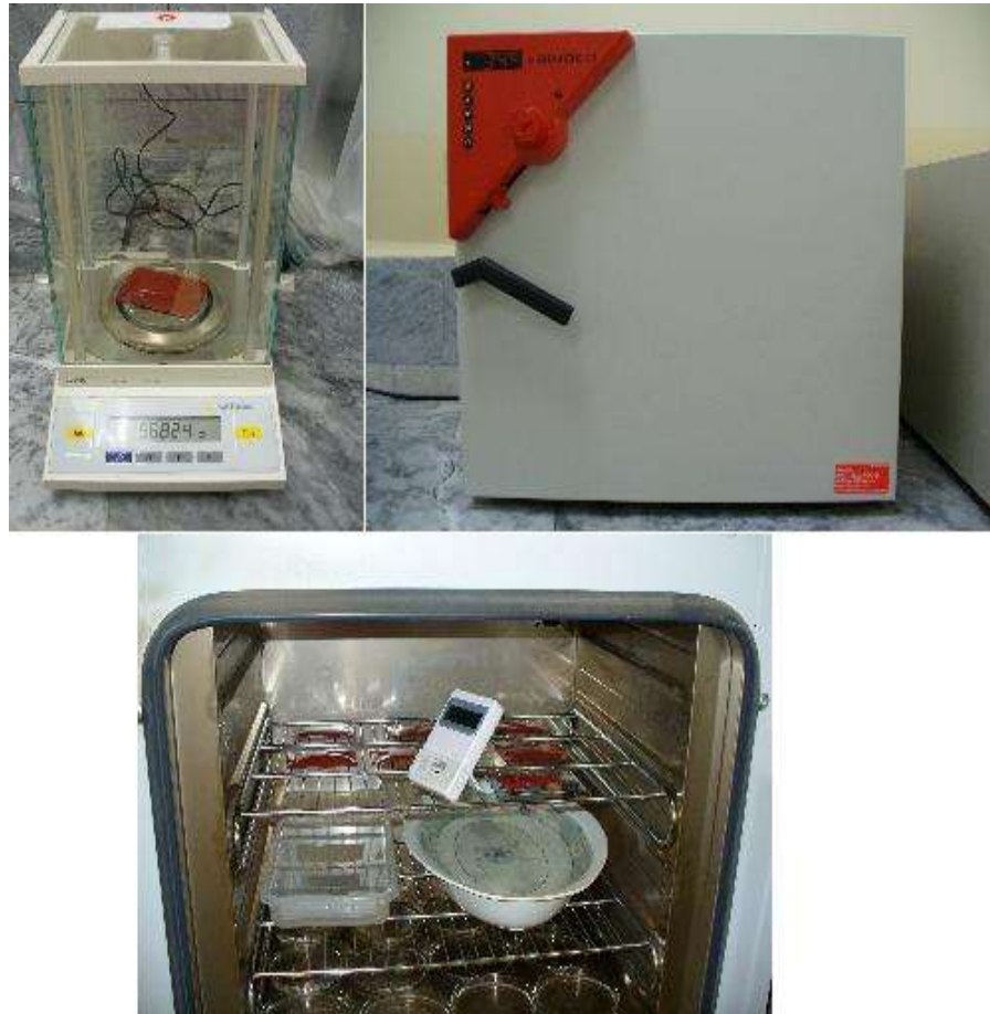
FIGURA 3.27. PRUEBA DE TRANSMISIÓN DE VAPOR DE AGUA ASTM D 1653.
