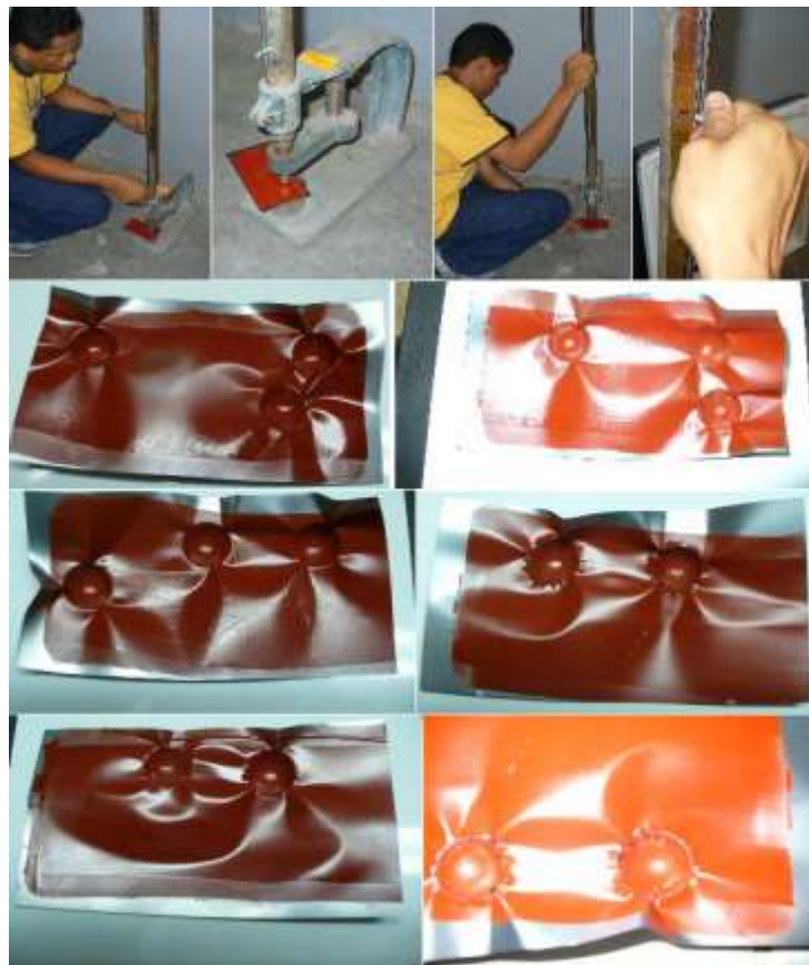
FIGURA 3.24. PRUEBA DE IMPACTO ASTM D 2794.
