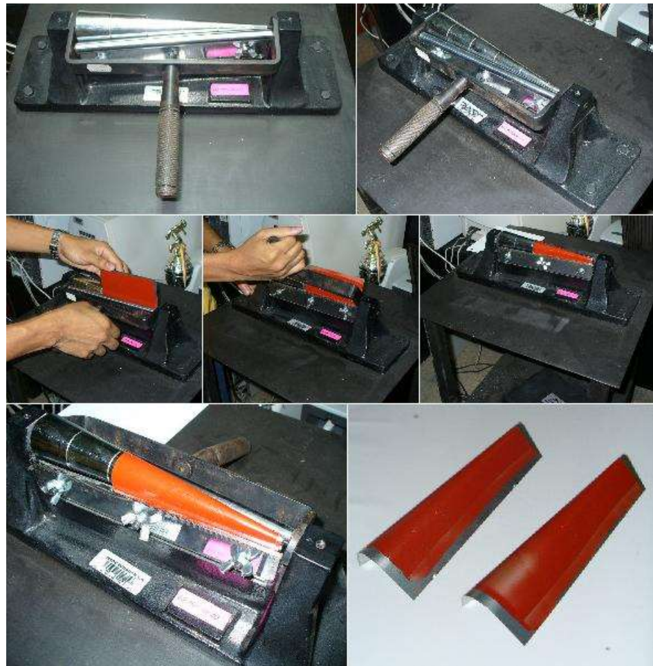
FIGURA 3.26. PRUEBA DE FLEXIBILIDAD ASTM D 522.
