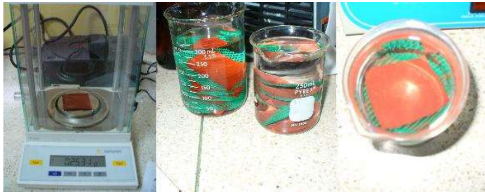
FIGURA 3.28. PRUEBA DE ABSORCIÓN DE AGUA ASTM D 570.
