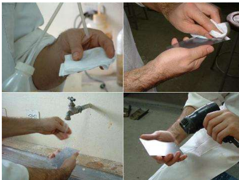
FIGURA 3.19. PROCEDIMIENTO PARA PREPARACIÓN DE PLACAS DE ACERO ROLADO EN FRÍO PARA SER PINTADAS.
