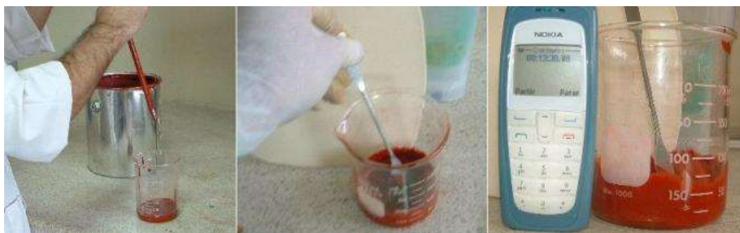
FIGURA 3.20. PROCEDIMIENTO PARA FABRICAR COMPUESTO DE RESINA EPÓXICA Y AGENTE CURADOR DC-010.
