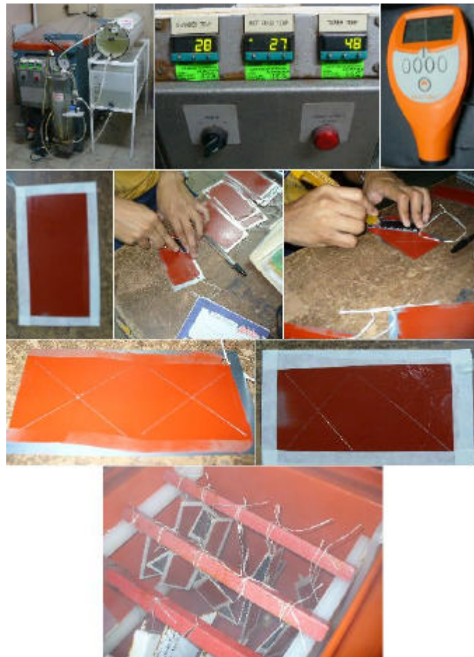
FIGURA 3.29. ENSAYO DE CORROSIÓN EN CÁMARA SALINA ASTM B 117 & D 1654.
