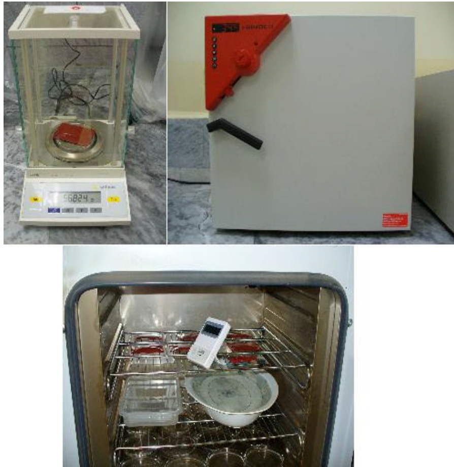
FIGURA 3.27. PRUEBA DE TRANSMISIÓN DE VAPOR DE AGUA ASTM D 1653.
