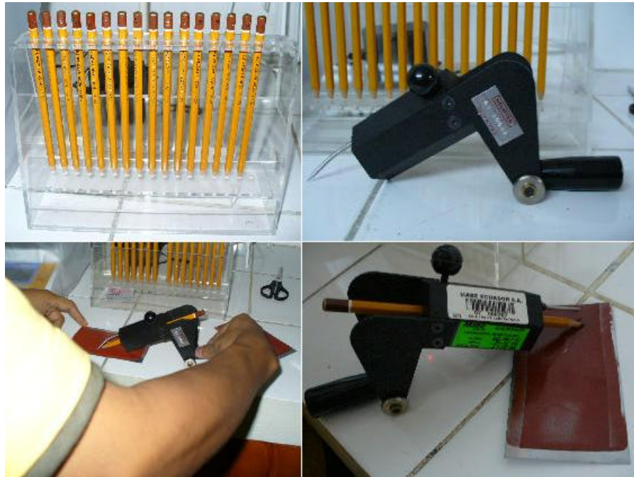
FIGURA 3.25. PRUEBA DE DUREZA AL LÁPIZ INEN 1001.
