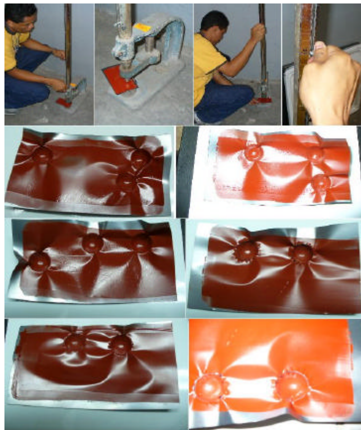
FIGURA 3.24. PRUEBA DE IMPACTO ASTM D 2794.
