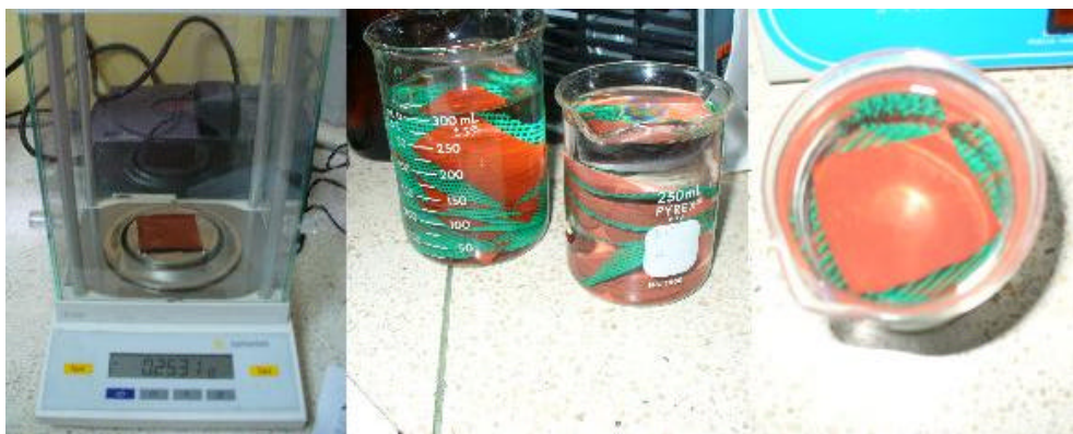
FIGURA 3.28. PRUEBA DE ABSORCIÓN DE AGUA ASTM D 570.
