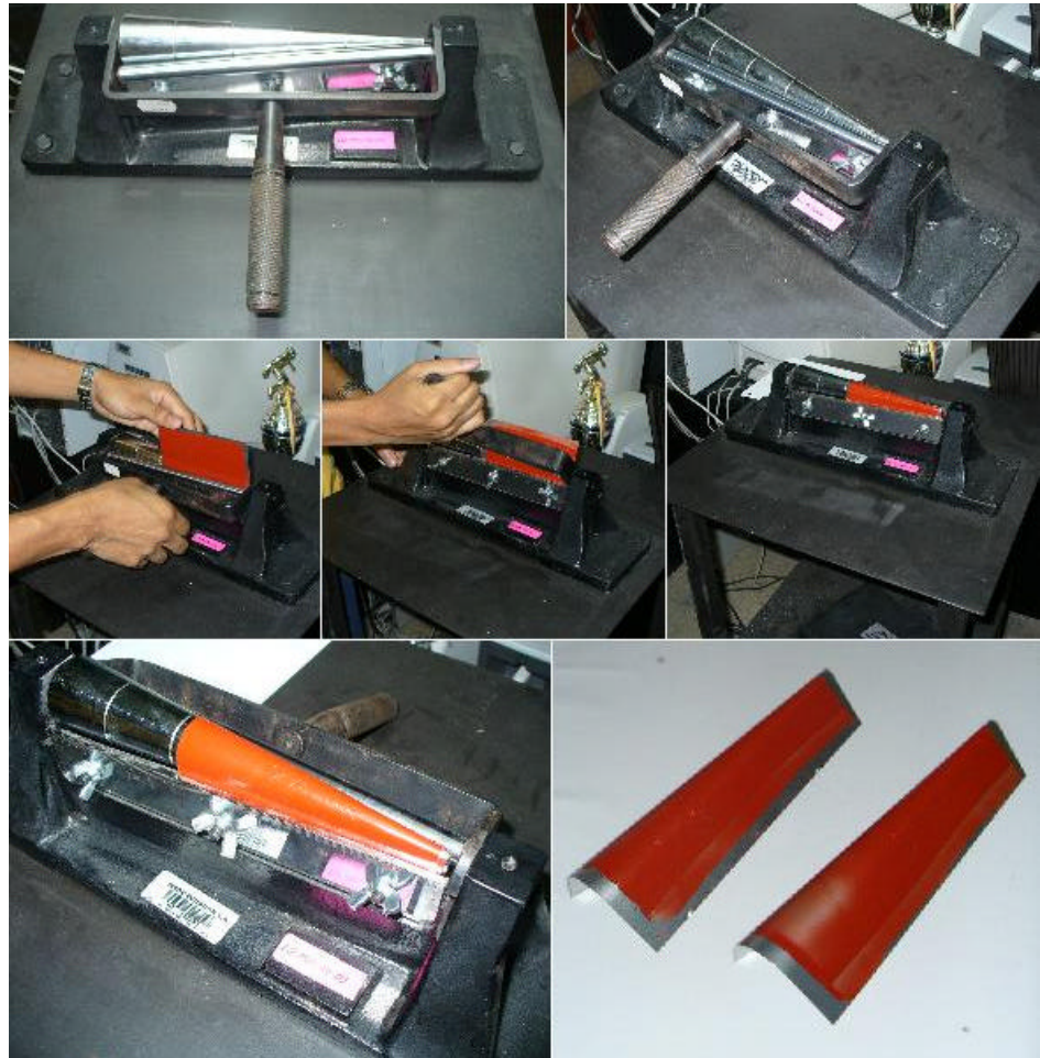
FIGURA 3.26. PRUEBA DE FLEXIBILIDAD ASTM D 522.
