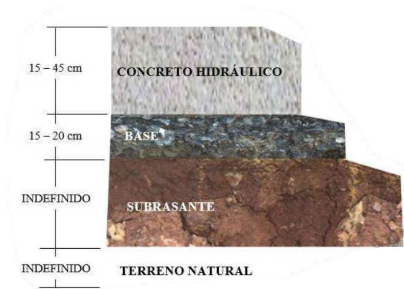
Ilustración 2. Sección típica de un pavimento rígido.
