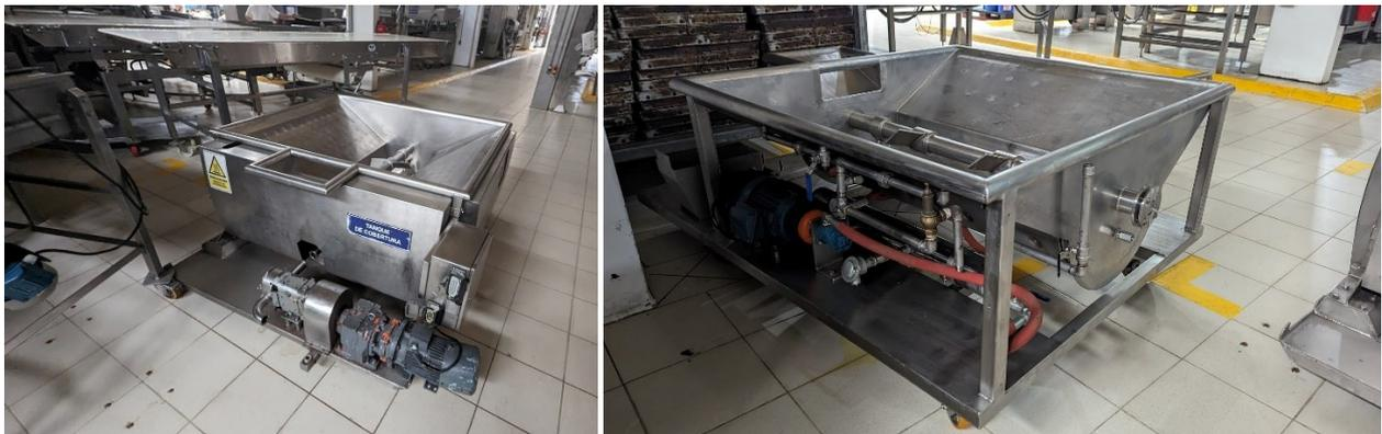
El nuevo proceso de cambio se representa con el diagrama de la Figura 2.22 lo que permite agilizar los procesos de cambio y limpieza antes mencionados al externalizar las actividades de limpieza y preparación del tanque y realizarlas en una zona apartada de la línea mientras se produce.
