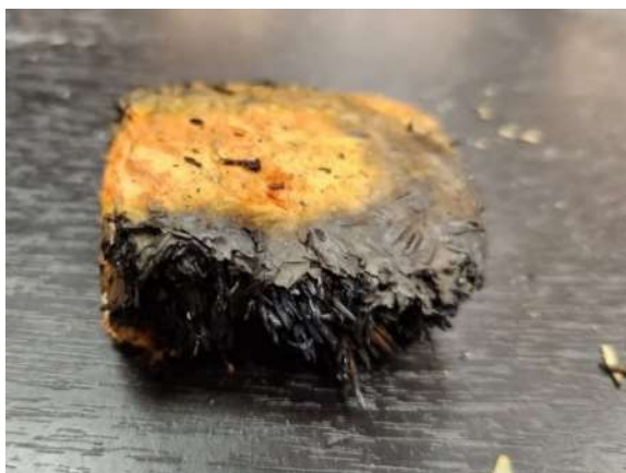
Figura 3.2 Muestra del biocompuesto sin recubrimiento tras exposición a la llama
