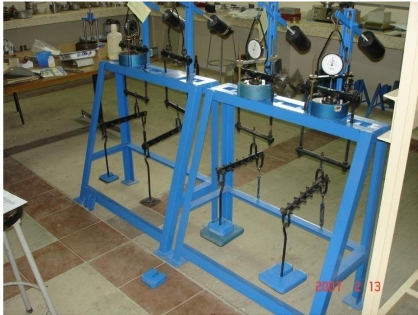
**FIGURA 4.61. PROCESO DE ENSAYOS DE EXPANSIÓN**
