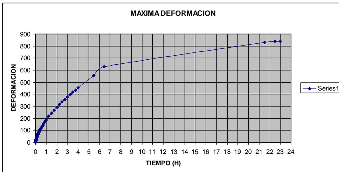
**FIGURA 4.67. GRAFICO DEFORMACIÓN V.S. TIEMPO DE ENSAYOS DE EXPANSIÓN SIMPLE, MUESTRA 4 PERFORACIÓN 2**
