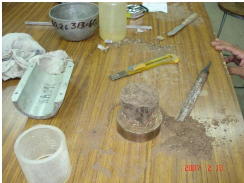
**FIGURA 4.56. MOLDEO DE MUESTRA PARA ENSAYOS DE EXPANSIÓN**
