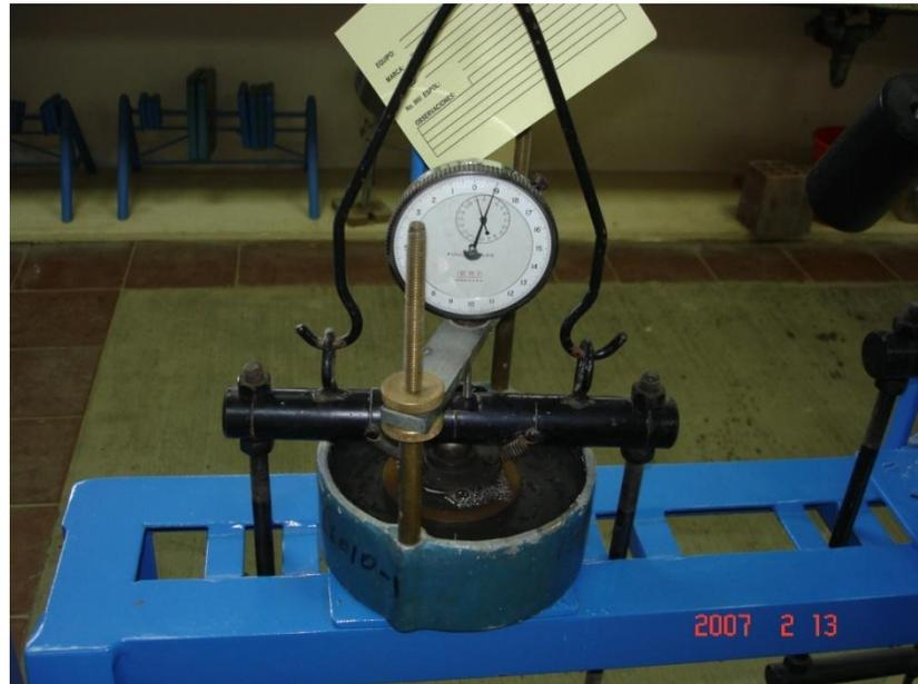
**FIGURA 4.59. EQUIPO PARA ENSAYOS DE EXPANSIÓN**
