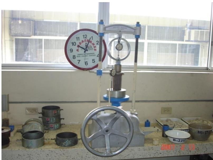
**FIGURA 4.49. MUESTRA, PRENSA Y DIALES DE COMPRESIÓN SIMPLE**
