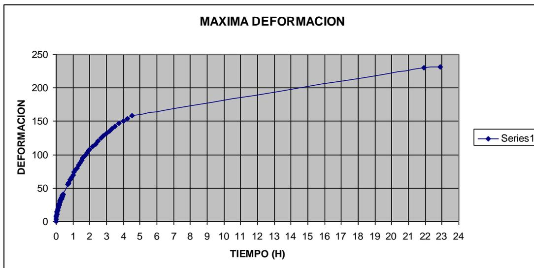
**FIGURA 4.66. GRAFICO DEFORMACIÓN V.S. TIEMPO DE ENSAYOS DE EXPANSIÓN SIMPLE, MUESTRA 2 PERFORACIÓN 2**
