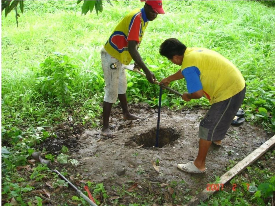
**FIGURA 4.41. PERFORACIÓN POR MEDIO DE ROTO PERCUSIÓN**
