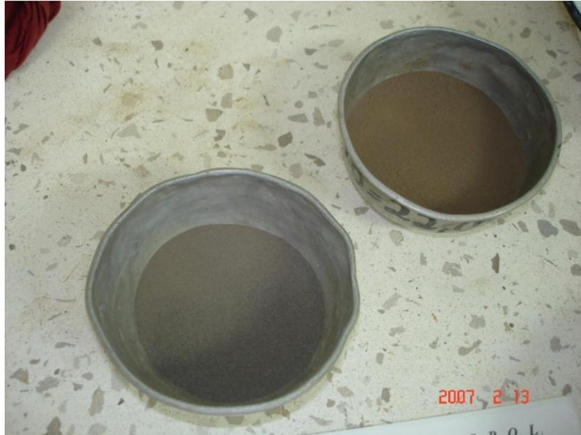
**FIGURA 4.53. MUESTRAS LISTAS PARA ENSAYO GRANULOMÉTRICO**
