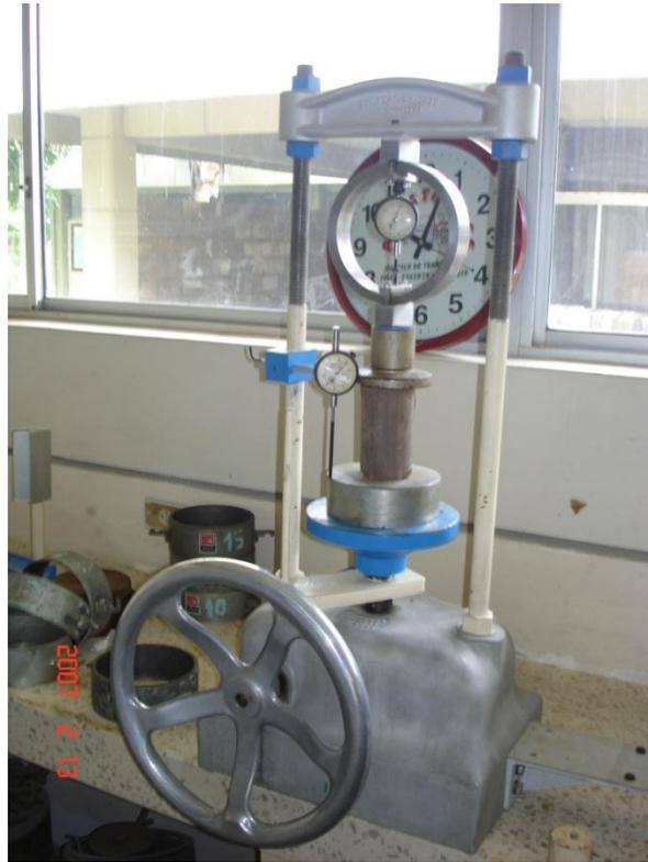
**FIGURA 4.48. MUESTRA, PRENSA Y DIALES DE COMPRESIÓN SIMPLE**
