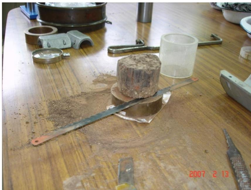
**FIGURA 4.57. MOLDEO DE MUESTRA PARA ENSAYOS DE EXPANSIÓN**
