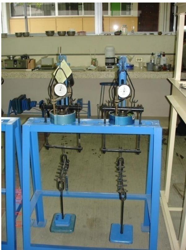
**FIGURA 4.62. PROCESO DE ENSAYOS DE EXPANSIÓN**
