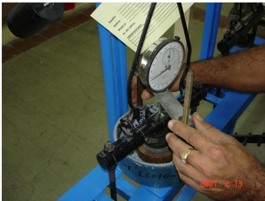
**FIGURA 4.58. PREPARACIÓN DE EQUIPO PARA ENSAYOS DE EXPANSIÓN**
