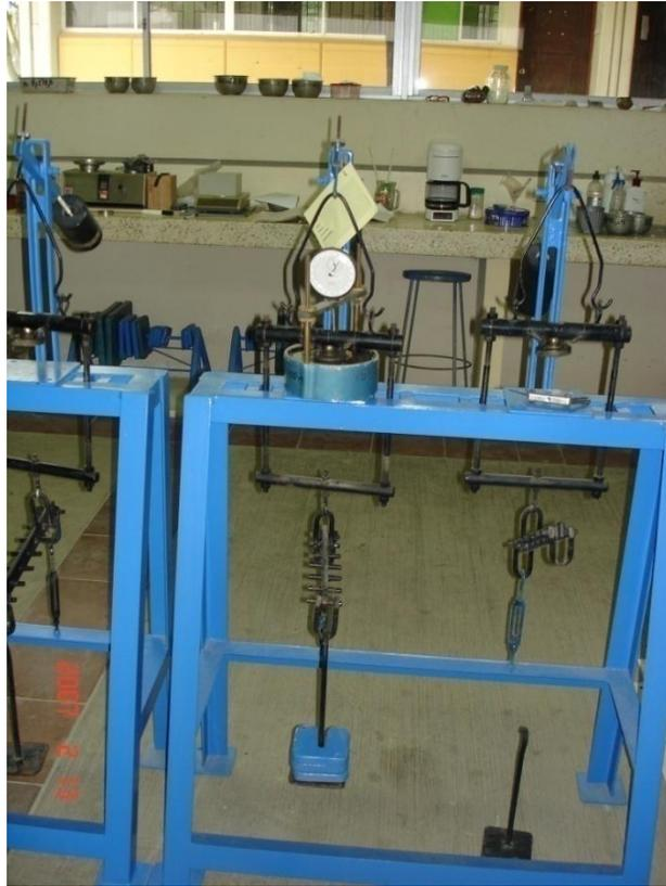
**FIGURA 4.60. PROCESO DE ENSAYOS DE EXPANSIÓN**
