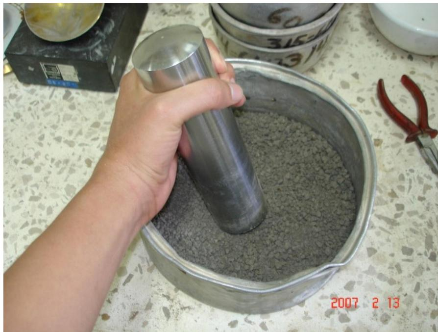
**FIGURA 4.52. MUESTRA EN PROCESO DE TRITURACIÓN**
