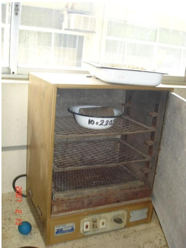
**FIGURA 4.51. MUESTRA EN EL HORNO**
