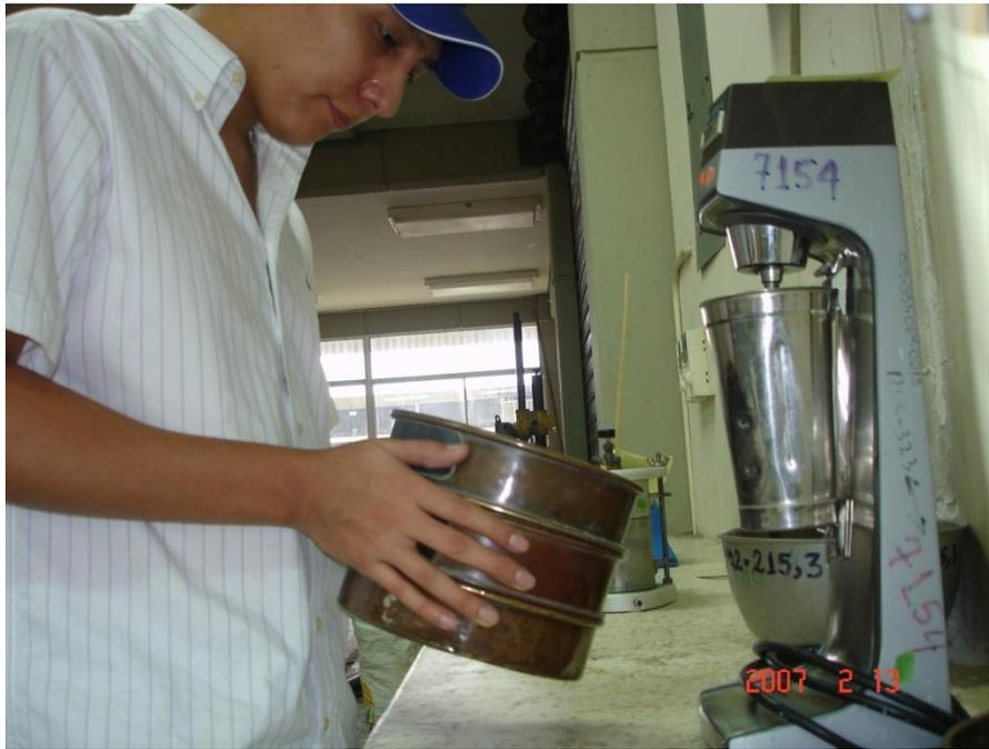
**FIGURA 4.54. MUESTRAS EN PROCESO DE TAMIZADO**
