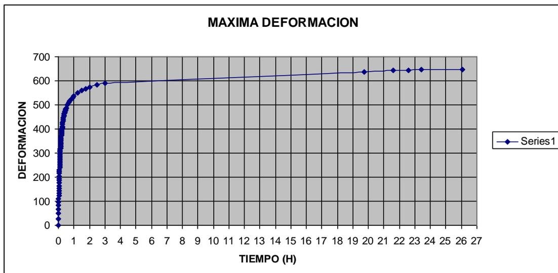
**FIGURA 4.65. GRAFICO DEFORMACIÓN V.S. TIEMPO DE ENSAYOS DE EXPANSIÓN SIMPLE, MUESTRA 5 PERFORACIÓN 1**
