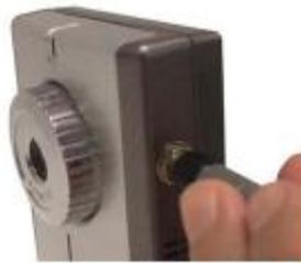
**Figura. 5.1 Conexión de antena**
