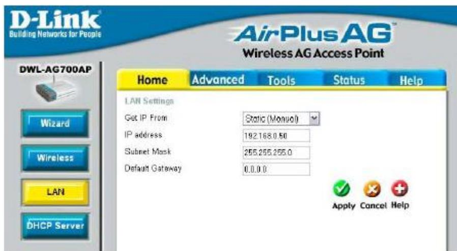
Figura. 5.29 Software Ventana ( 1 ) Configuración de la Dirección IP del Ruteador
