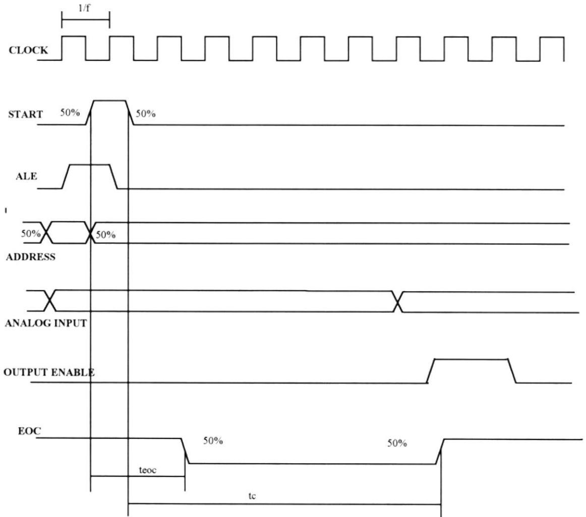
Fig. 2.4 Diagramas de Tiempo del ADC0808
