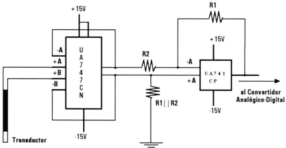
**Fig. 2.7 Diagrama del Bloque Acondicionador de Señal**
