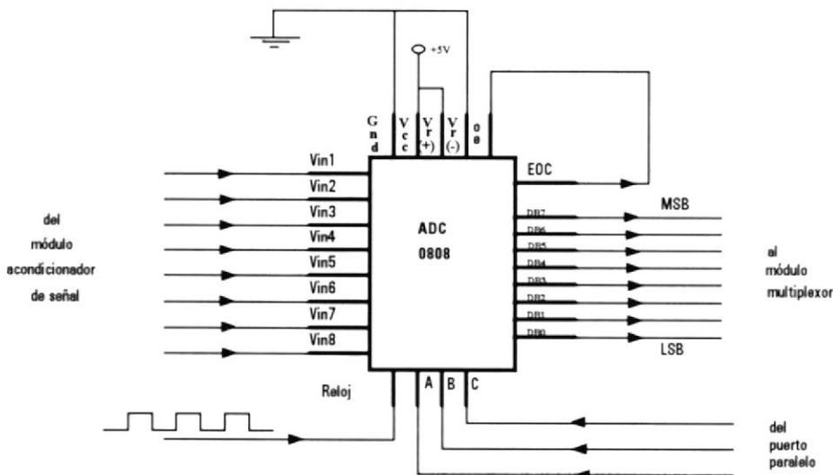
Fig. 2.8 Diagrama del Módulo Convertidor Analógico Digital
