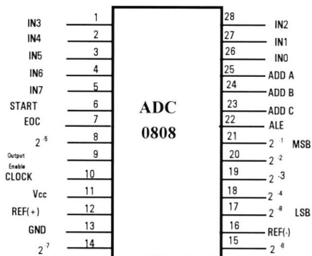
Fig 2.3 Diagrama de Conexión del ADC 0808
