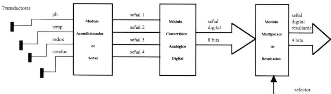
**Fig.2.5 Diagrama de Bloques de Circuitería de Adquisición de Datos.**
