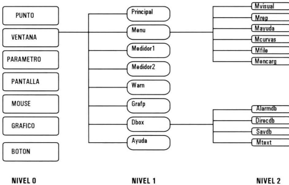
**Fig. 4.1 Diagrama Jerárquico de Clases Utilizadas**
