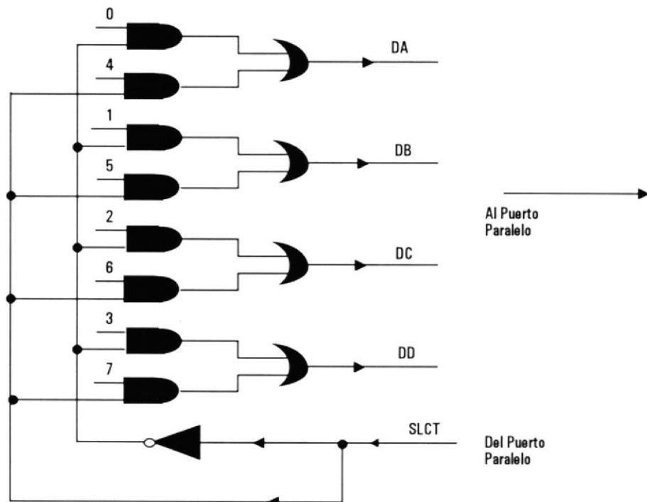
**Fig 2.9 Diagrama del Módulo Multiplexor de Señal Resultado**
