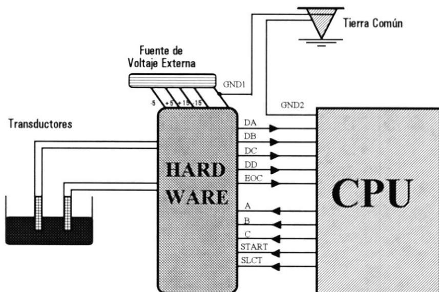
**Fig. 3.2 Conexión a Tierra del Sistema.**
