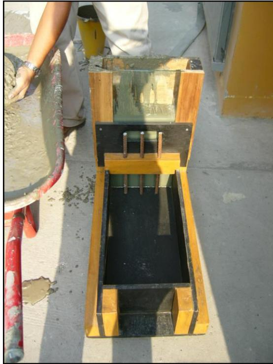
**FOTO 29. ENSAYO CAJA L**
