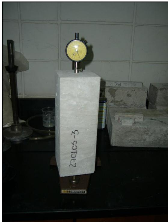
**FOTO 24. ENSAYO DE RETRACCION DE VIGAS**
