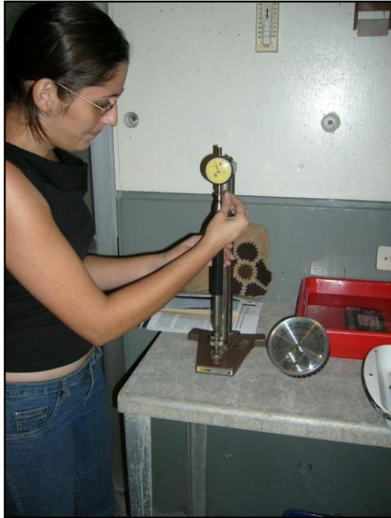
**FOTO 23. DEFORMIMETRO PARA MEDIR RETRACCIONES**
