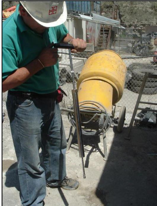
**FOTO 13. PENETROMETRO PARA MEDICION DE FRAGUADO**
