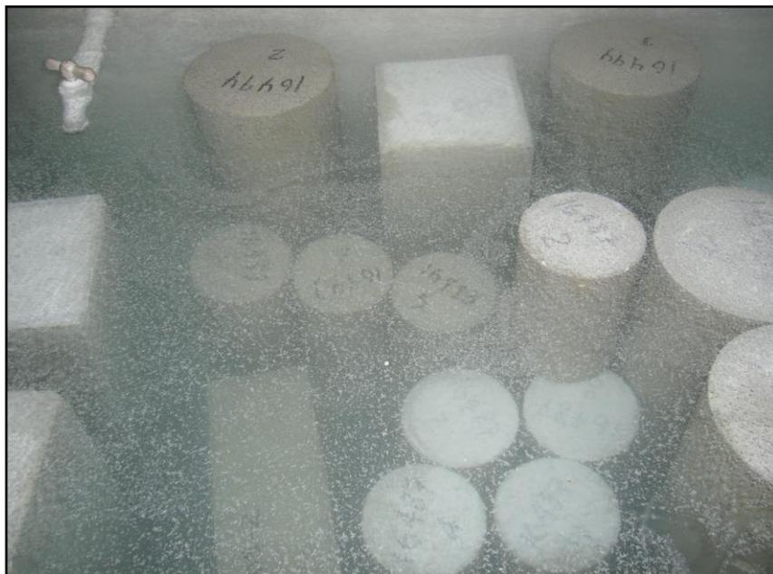
**FOTO 20. CURADO DE CILINDROS Y VIGAS**
