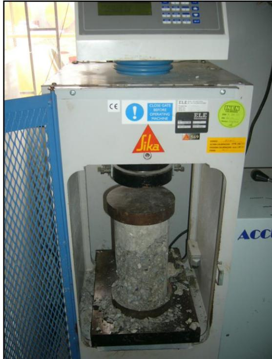
FOTO 31. ENSAYO A LA COMPRESION
