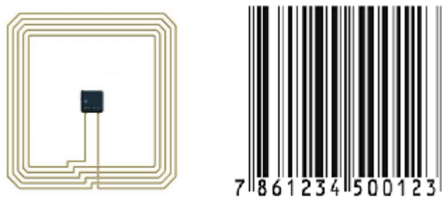
Figura 2. Tecnología RFID vs Código de barras
