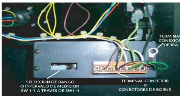
**FOTO 12. AJUSTES DEL RANGO DE INTERVALO DE MEDICION**
