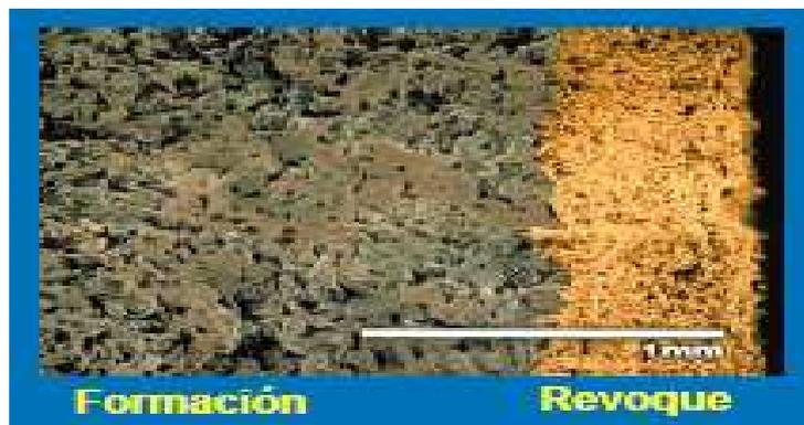
**Figura 2.1 El espesor del revoque es fácilmente removido con bajas presiones de producción.**
