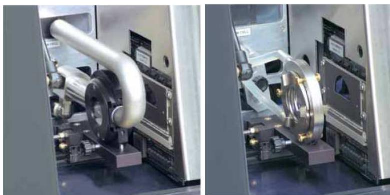
**Figura 1.13 Celda medidora en seco y en líquido**
