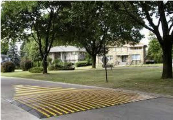
*Nota.* La figura muestra un reductor de velocidad tipo meseta de caucho. Fuente: (Cactus Traffic, 2020)
