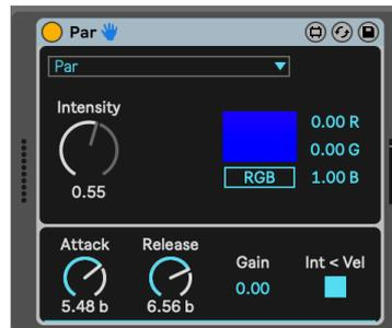
Figura 3.3 Control de la intensidad del color azul en luces led DMX
