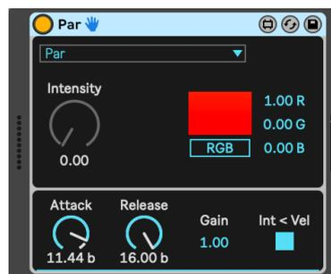
Figura 3.6 Control de la intensidad del color rojo en luces led DMX
