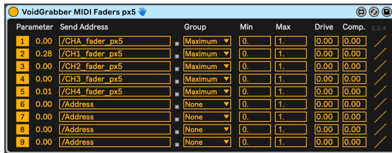
Figura 3.12 Mapeo MIDI de deslizadores de canal a direcciones de envio OSC
