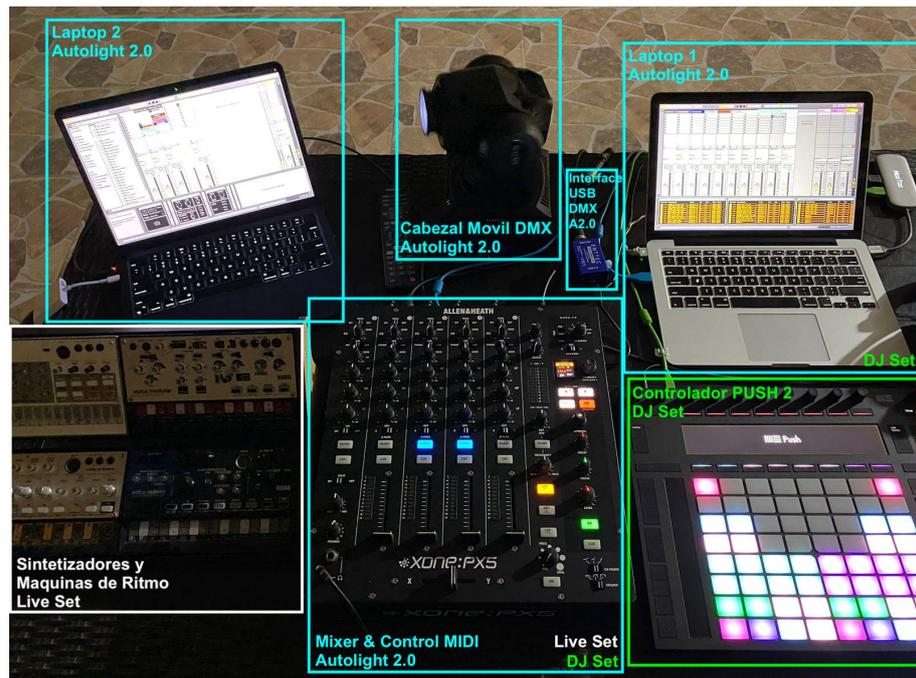
Figura 3.20 Instalación del sistema Autolight 2.0 en DJ Set y Live Set
