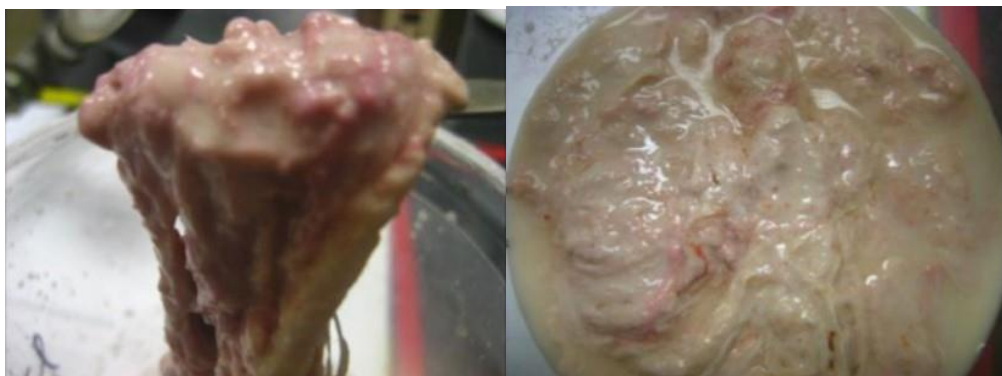
Figura 3-6: Reticulación de glutaraldehído de un sistema FLOPRO NT con KLA-STOP (Schlumberger Private, 2022)
