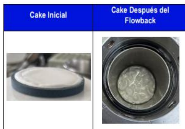
Figura 4-1: Cake inicial y después del Flow back (Autores, 2023)
