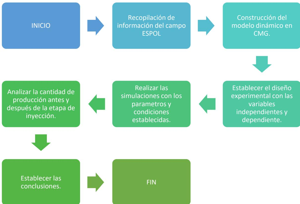
Figura 2.1 Diagrama de flujo para establecer la inyección de químicos.
