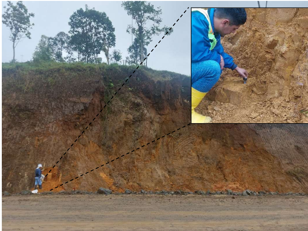
Figura 3.6 Ejecución de ensayo de veleta de bolsillo para el sitio 4.
