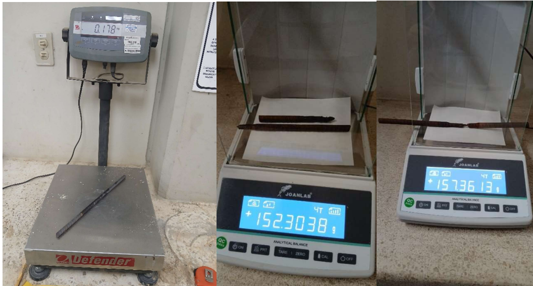
Figura 20 Pérdida de Peso en Barra de Acero
