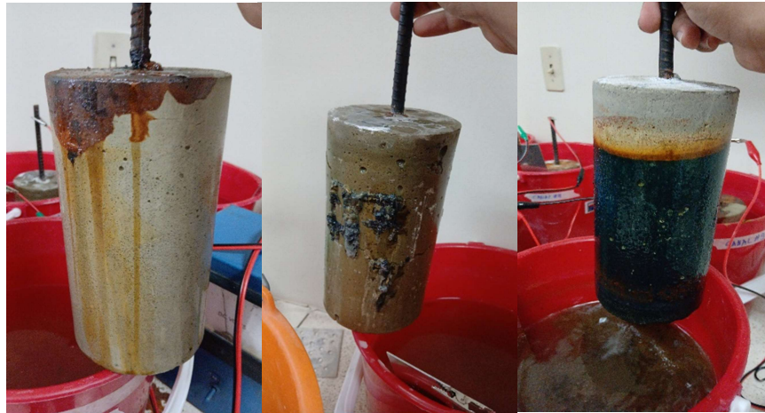
Figura 18 Falla de Cilindros
