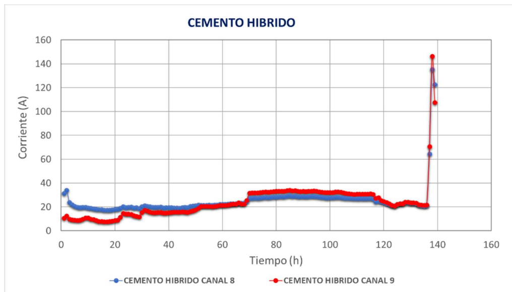
Figura 23 Grafica Corriente - tiempo Cemento Híbrido (CH)
