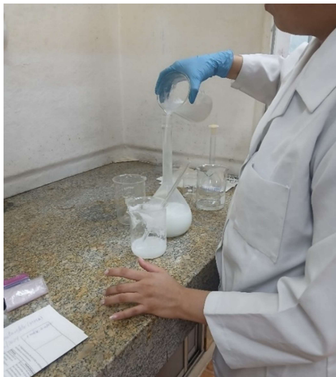
Figura 6 Preparación del Hidróxido de Sodio
