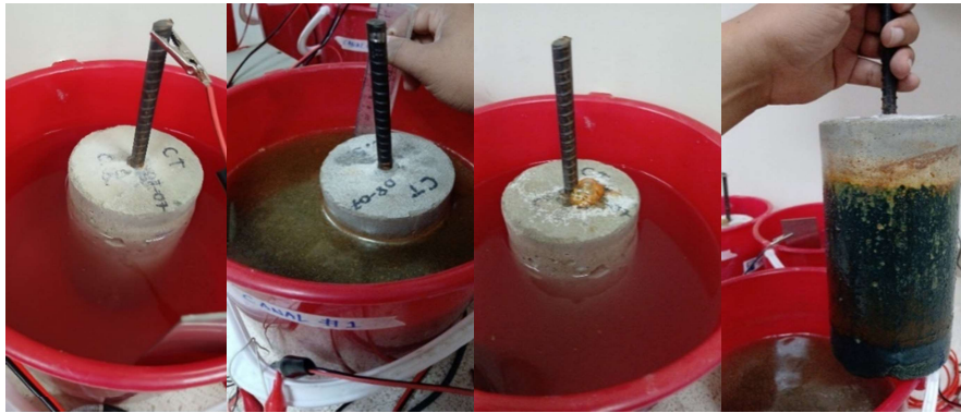
Figura 16 Corrosión en muestras de CT y CH
