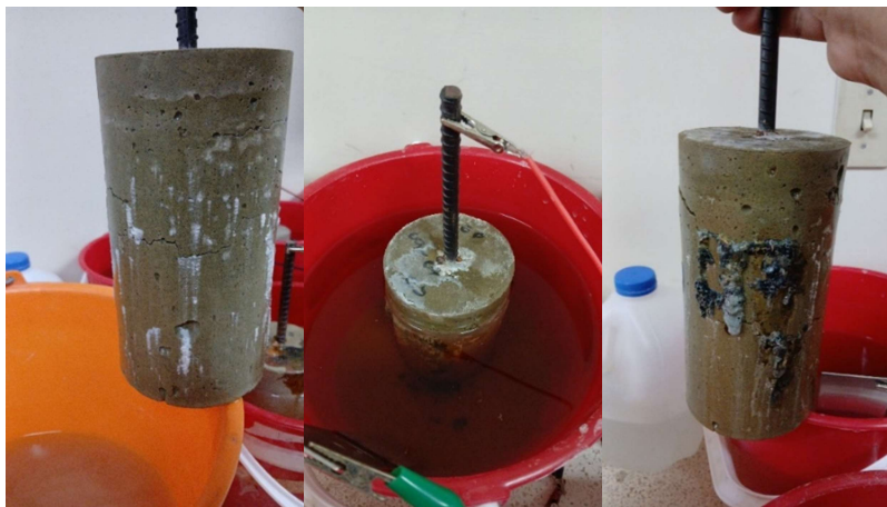
Figura 17 Corrosión en muestras de Geopolimeros
