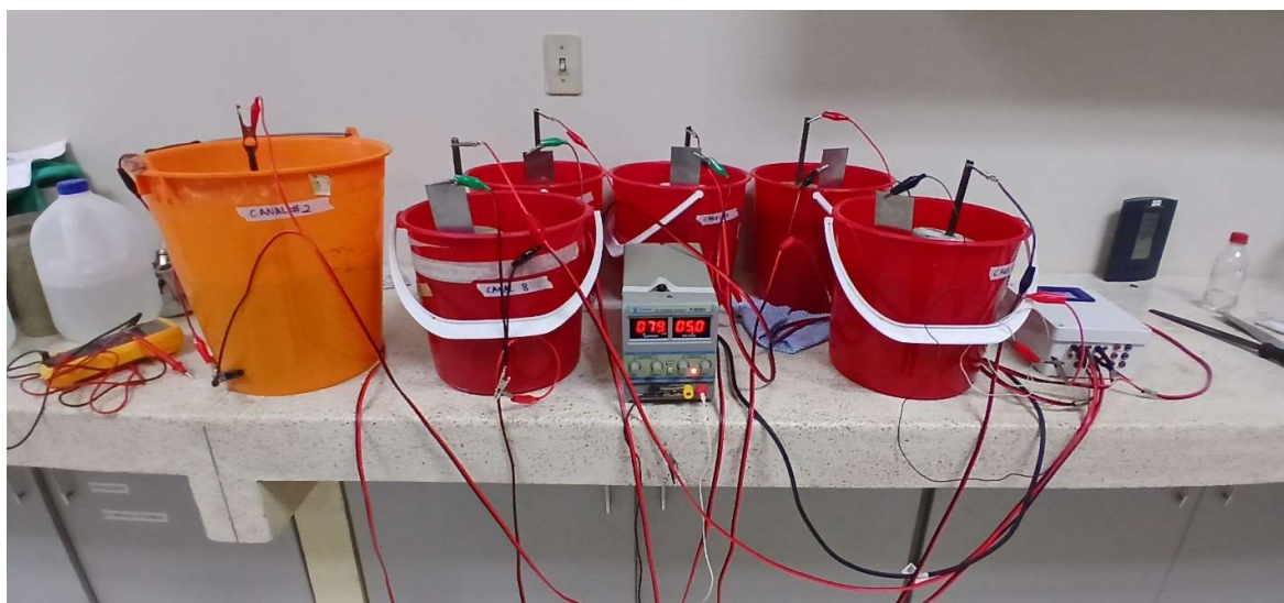
Figura 13 Montaje de ensayo de Corrosión Acelerada
