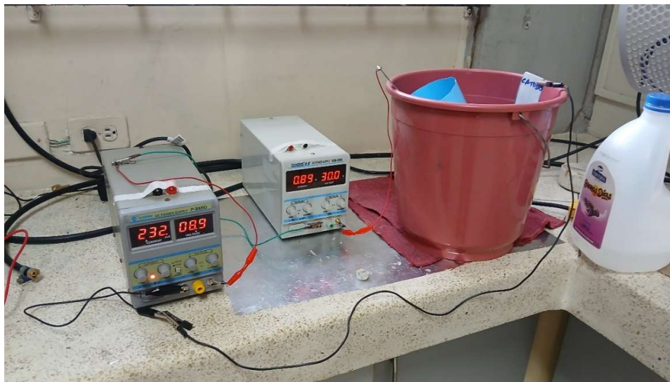
Figura 15 Montaje Ensayo de Difusión de Cloruros
