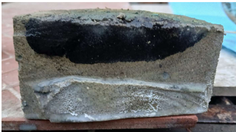
Figura 30 Penetración de Cloruros en Geopolímeros
