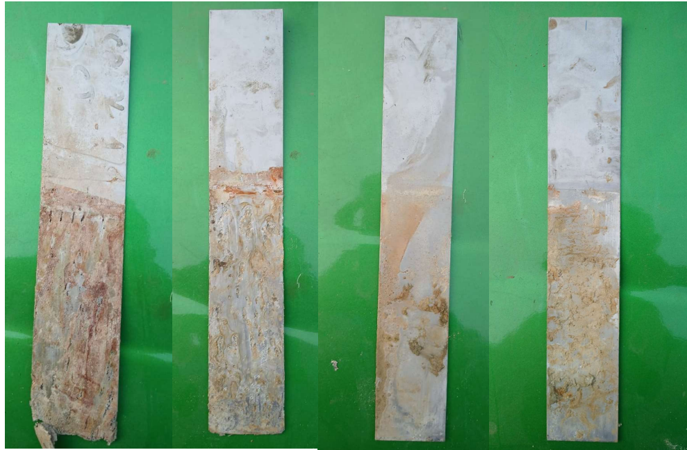
Figura 21 Corrosion de placas de Acero Inoxidable
