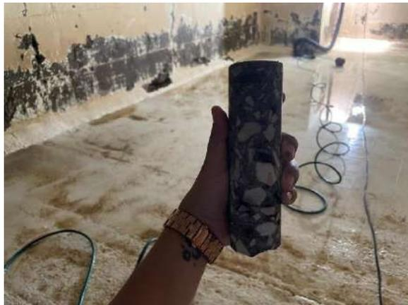
**Ilustración 9: Núcleo perforado**
