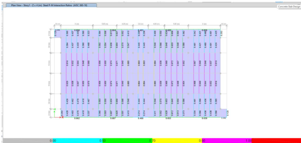
Ilustración 3.5. Relación de capacidad de vigas secundarias
