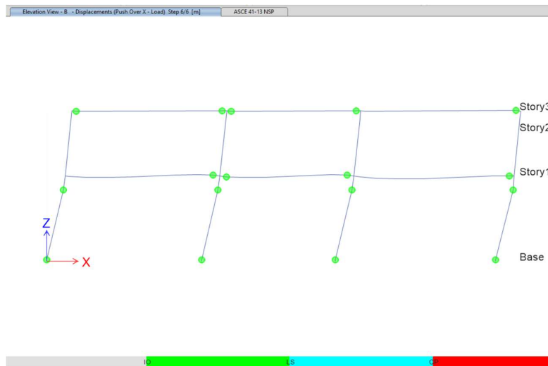
Ilustración 59 Primeras Rótulas Plásticas en Base de Columnas y vigas -Seguridad De Vida-paso 6 (Autores, 2024)
