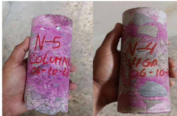
Ilustración 5 Carbonatación en hormigón (Alexis Javier Jama Zambrano, 2023)
