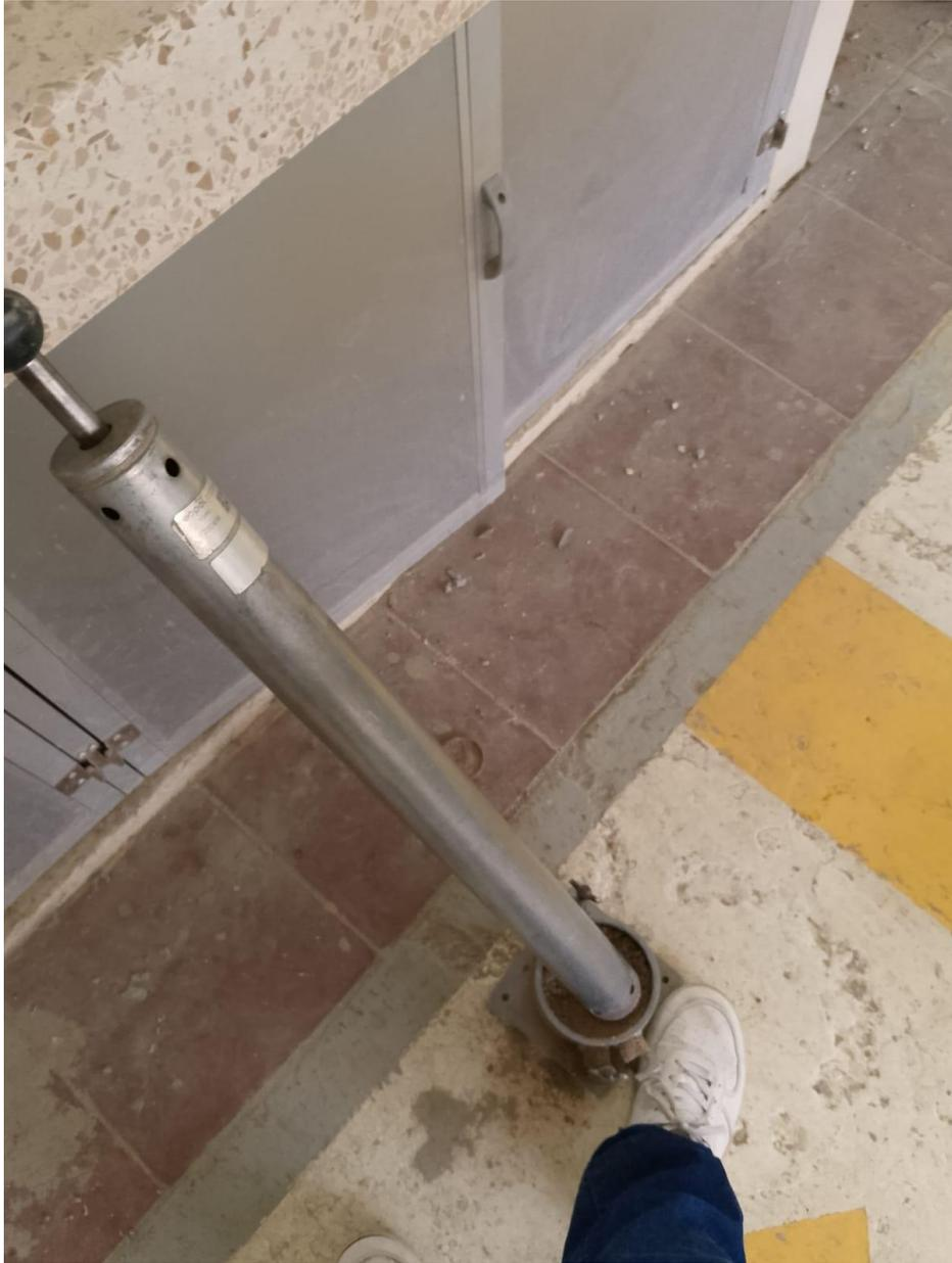
**Ilustración 0.7 Ensayo Proctor modificado**
