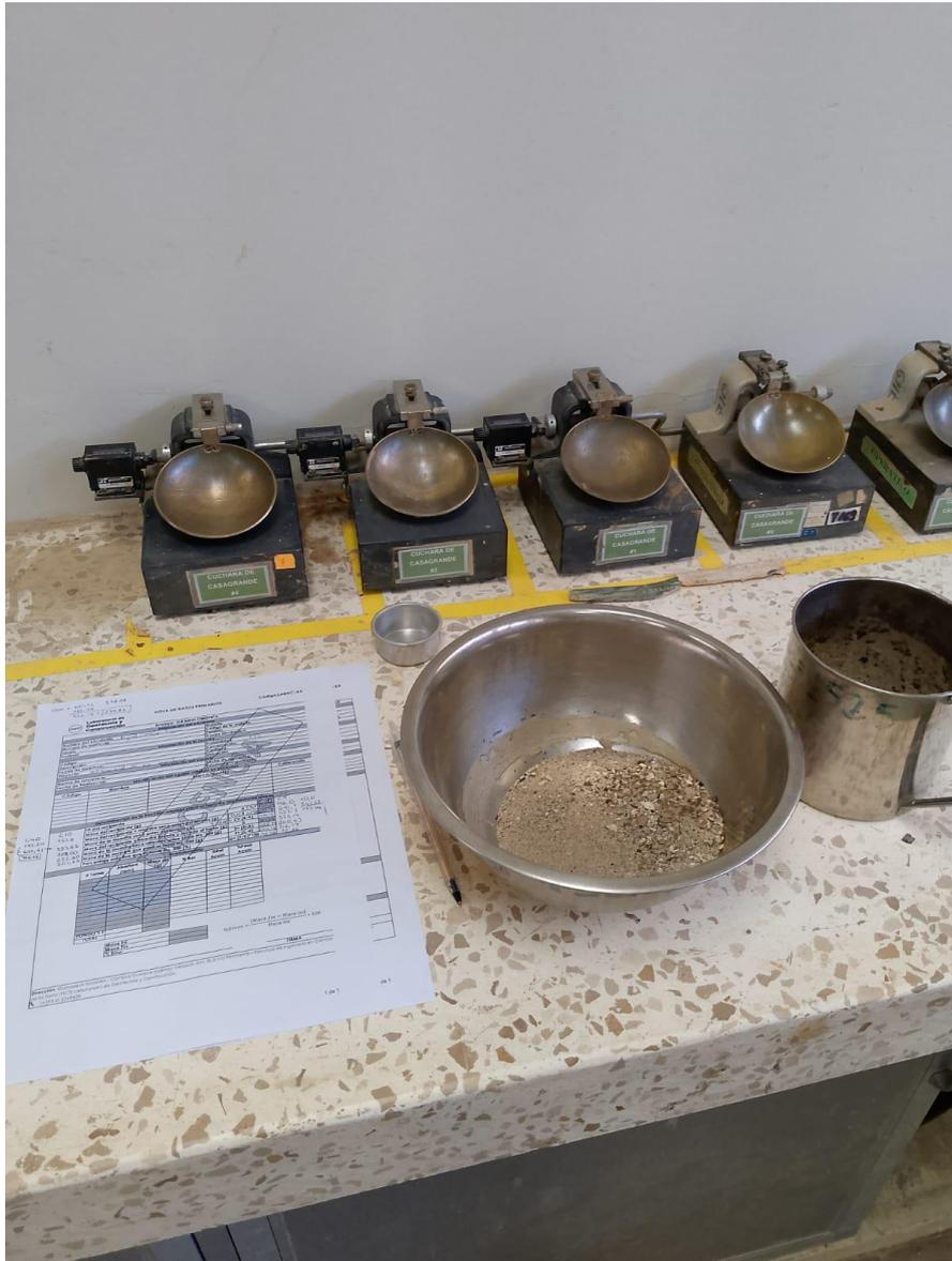
**Ilustración 0.12 realización del ensayo límite de attenberg**
