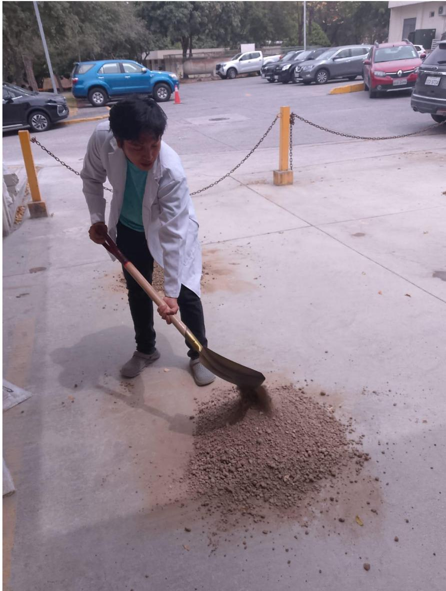
**Ilustración 0.11 Cuarteo de la muestra para ensayos**
