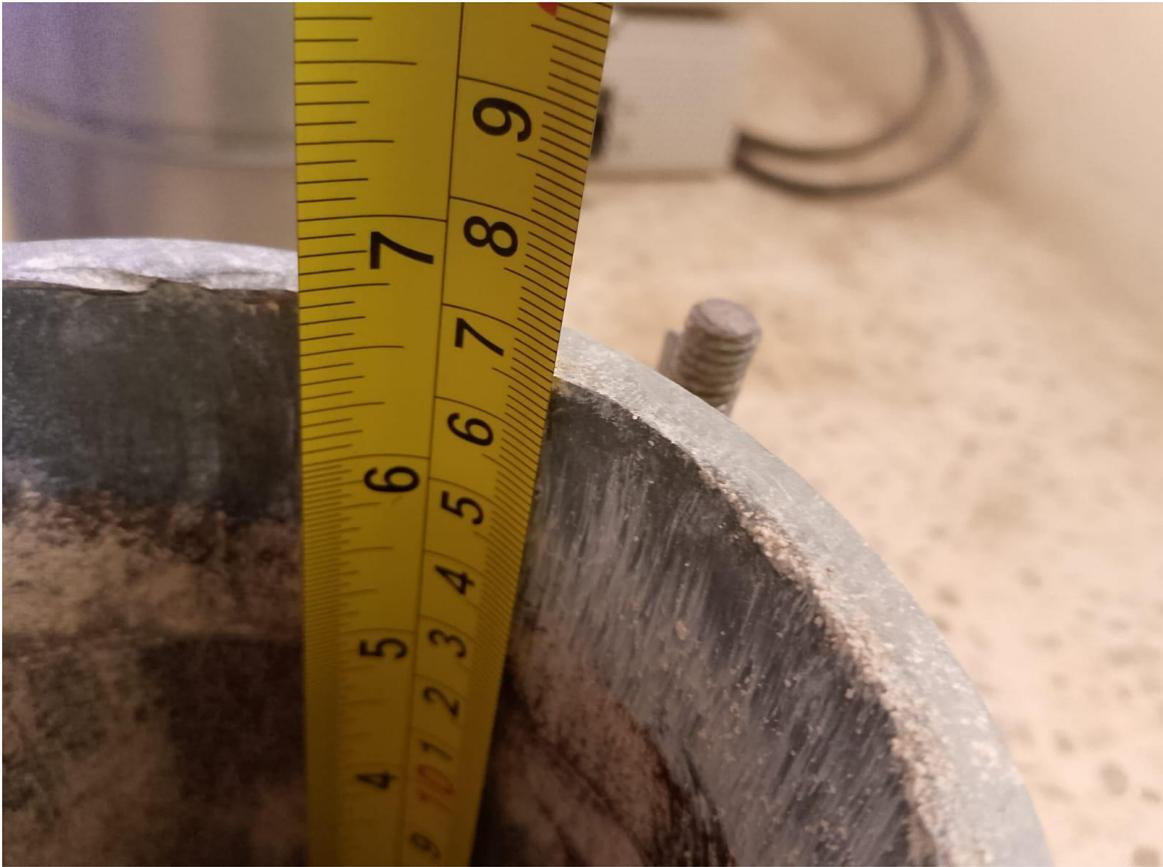
**Ilustración 0.4 medición del recipiente para cálculo de CVR**
